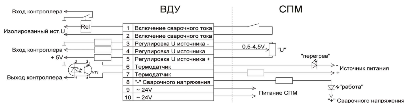
Схема подключения механизма подачи СПМ или ДУ.
