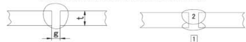
Параметры для сварки встык (Справочно).
